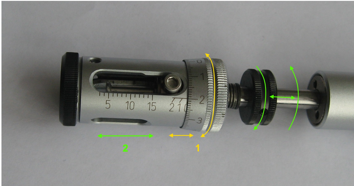
Abbildung 4: Einstellung am MiniStrip. 1-Innendurchmesser, 2-Abisolierlänge
